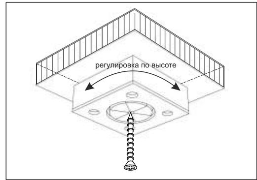
6. Крышки 4 прикрепить к боковинами 1, 2, 3 при помощи еврошурупов 7\*50 мм.
