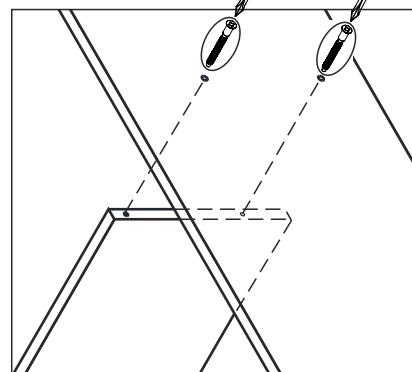
Отверстия диаметром 5 мм
